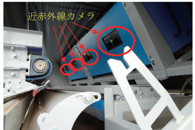
写真6 自動選別機に搭載された4台の近赤外線カメラ
