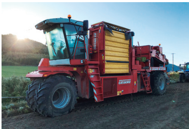
写真3 ばれいしょの自走式2畦ハーベスタ (写真提供：有限会社だいち)
