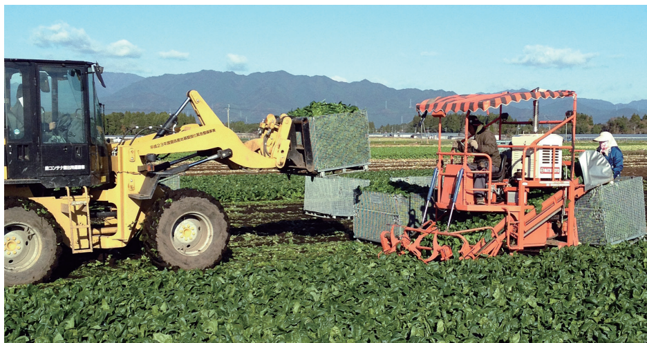
写真1 冷凍用ほうれんそうの機械収穫の様子
