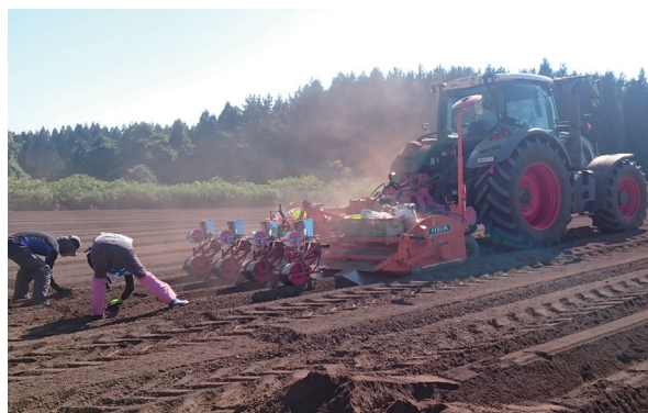
写真3 テープシーダーによる播種作業
