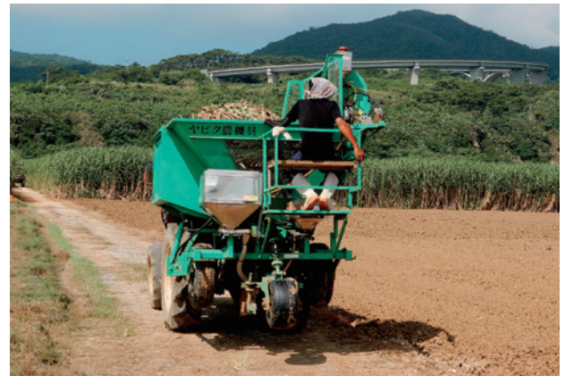
写真7 ピレットプランタ（一度に多量の苗を投入）
