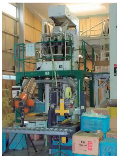
写真10 ピーマン自動計量包装機業
