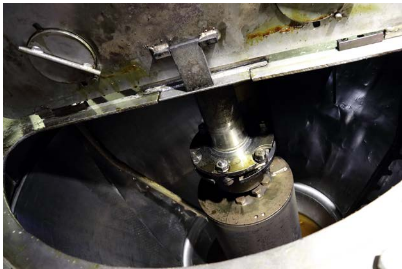
遠心分離機(QLD州の製糖工場にて撮影)
