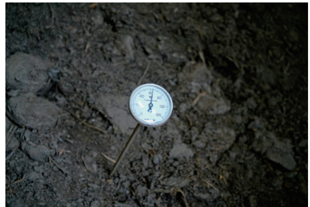
写真3 温度や堆肥の色味、水分量などを見ながら発酵の状態を確認（写真の機器は温度計）
