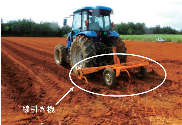
写真2 自動操舵システムを搭載したトラクタと線引き機（農業生産法人アグリサポート南大東株式会社提供）
