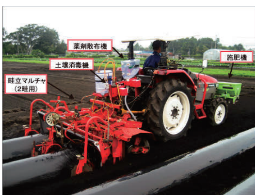
写真1 植え付け前作業の一工程作業機
