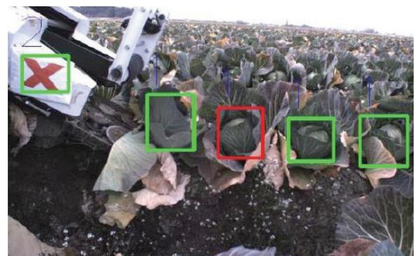
写真5 キャベツ認識と高さ計測
