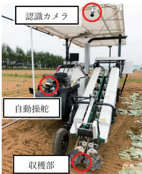
写真2 キャベツ自動収穫機
