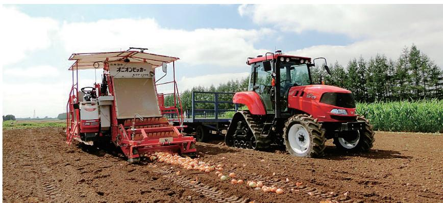
写真9 たまねぎ自動収穫機と自動並走トラクタ
