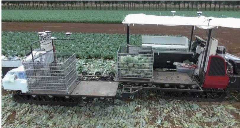
写真6 コンテナの収穫機(右)から運搬車(左)への自動移動
