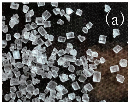
写真5 種として使われる(a)グラニュー糖の直方体に近い結晶の光学顕微鏡写真、(b)一粒のケシの実、(c)一粒のいら粉の電子顕微鏡写真。
