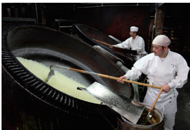
写真3 金平糖を作る巨大な円形の鍋。55度程度に保温された鍋をゆっくり回転させながら糖蜜をかけたりコテでかき混ぜたりする。（緑寿庵清水提供）
