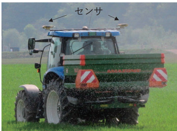
写真1 センシングに使用した生育センサ
