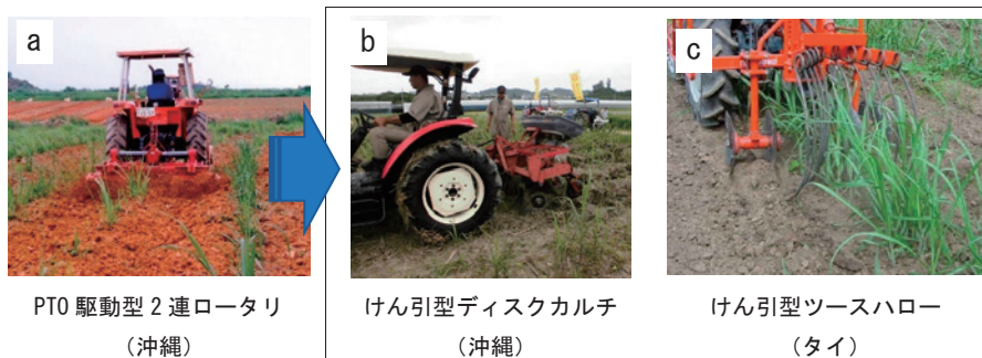
図11 畝間管理機：PTO駆動型とけん引型（中型トラクタ用）
