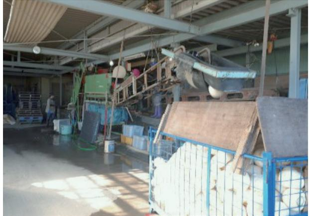
写真7 コンベアで洗浄機から出荷用
