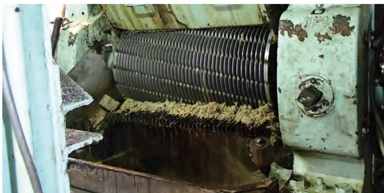
写真2 工場のさとうきびの压榨機
