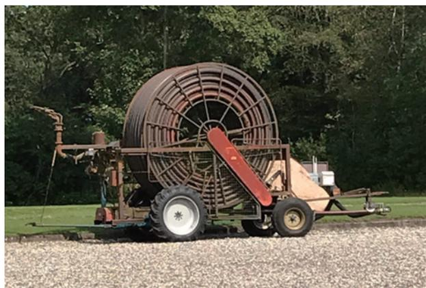
写真5 濁水時に利用される灌漑設備。電気を使って500メートルの距離にわたって散水できる。1台約10万ユーロ（1220万円）とされる。
