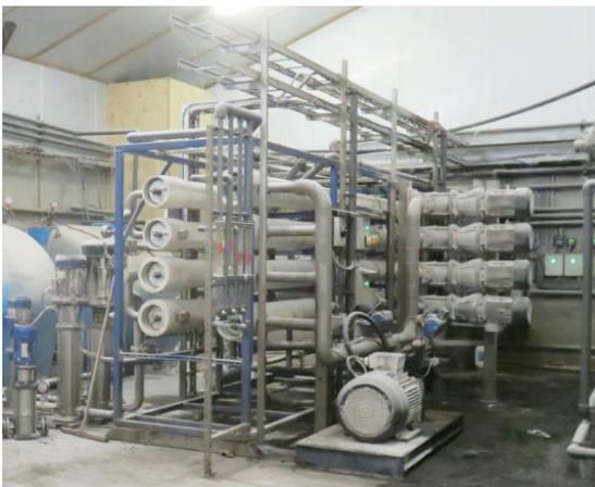
写真4 逆浸透膜（ミネラル濃縮物製造）北ブラバント州の養豚生産者
