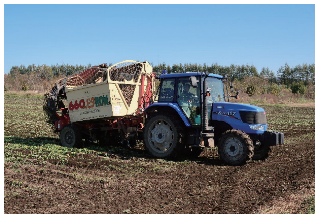
写真：コントラクターによるてん菜の収穫風景 (機械は補助事業を活用して導入したトラクターとビートハーベスタ)
