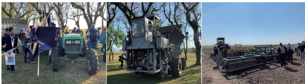
写真6 INTAで開発されている農機 （左から刈り倒し機、大型ピレットプランタ、ディスクハローなどの土壌管理機）
