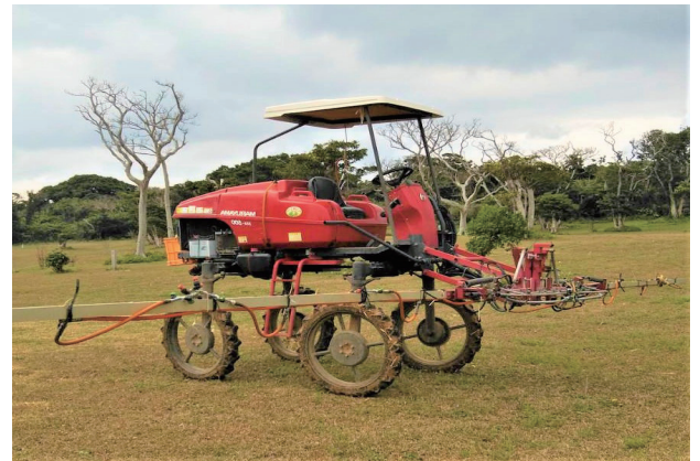
写真1 城久集落受委託部会の担い手生産者が使用するブームスプレイヤー
