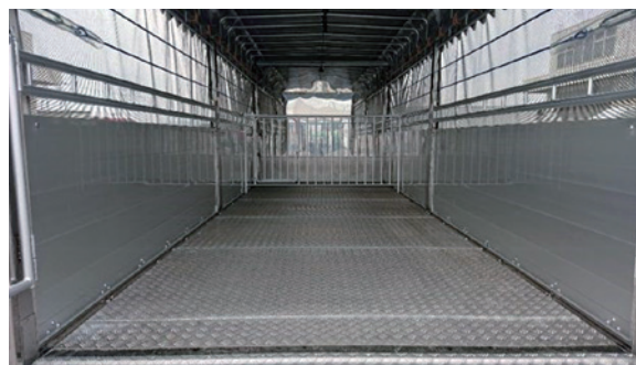
写真2 運搬車の車内の様子 仕切り柵があることによって、子牛と経産牛を同時に運搬することができる。
