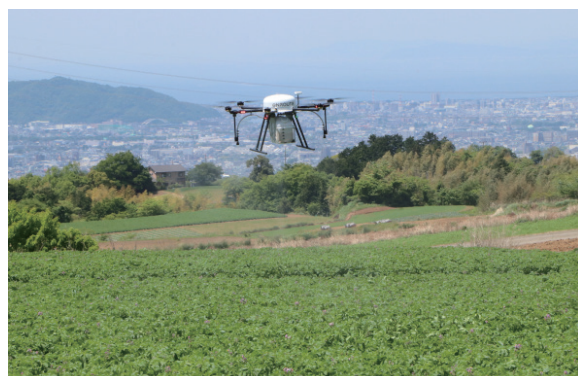
写真2 飛行の高さを低く抑えてドリフトを抑制
