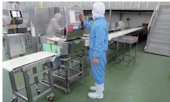
写真8 (6) 検査機器(金属探知機)
