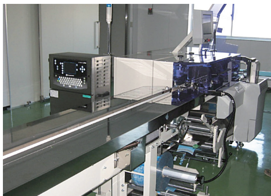
写真5 鮮度保持密封包装技術（ベジブレスパック）
