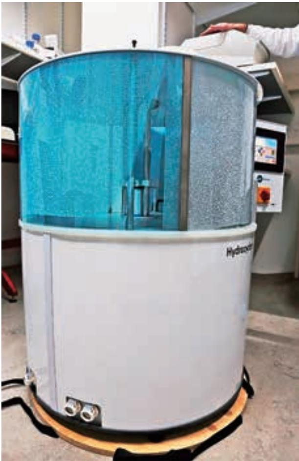
サーマルサイクラー（通常の実験室に配備されるPCRを行う機械）14台分のサンプルを一度に処理できるHydrocyclerを使ってDNAマーカー検定を行っている。
