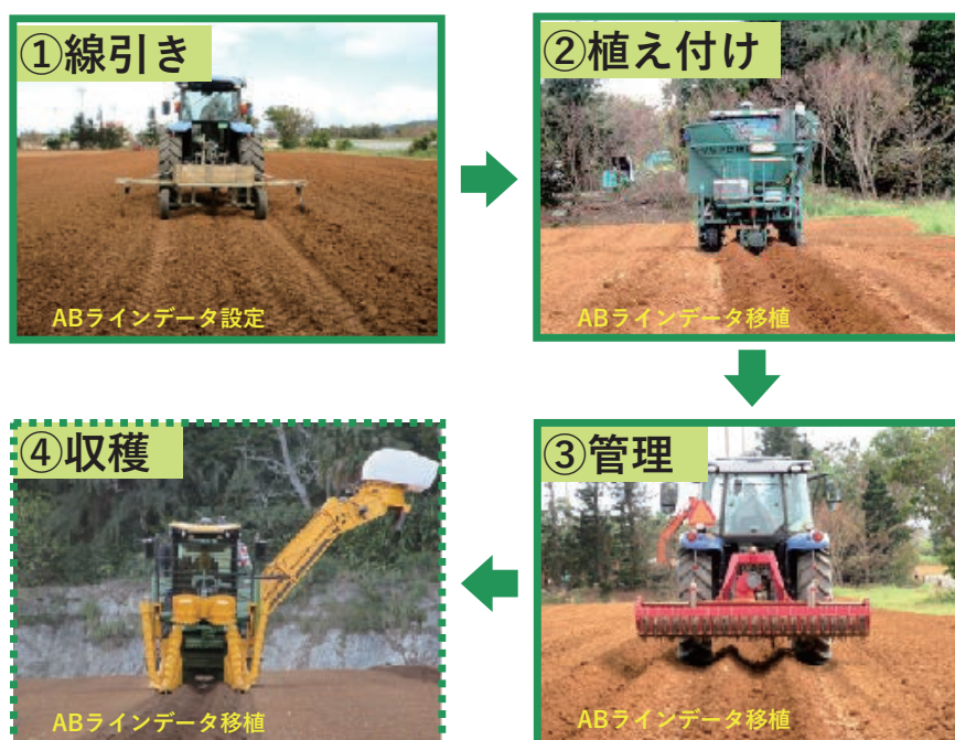
写真6 GNSS自動操舵作業体系のためのABラインデータの取得と移植
