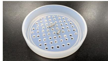
図 4 皮膚ガスの捕集にもちいたテフロンシャーレと固相吸着材。
