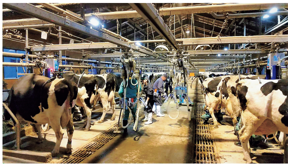
写真1 自動搬送によるパイプラインミルクカー
