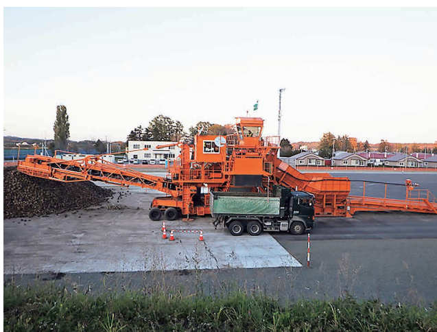
写真3 製糖工場のパイラー（慣行の除土機）
