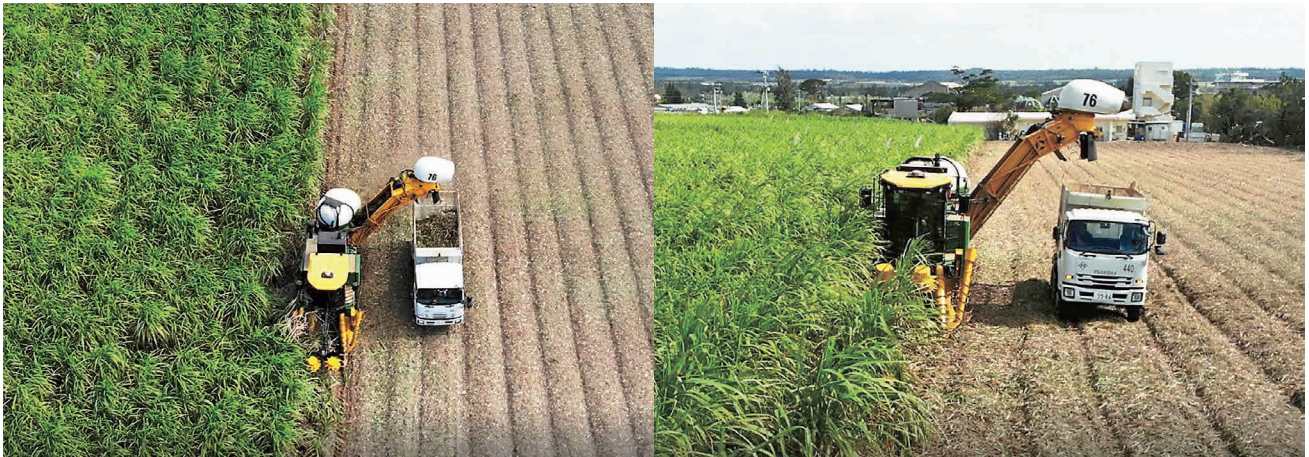
写真10 ドローン空撮画像（GNSS自動操舵収穫作業）
