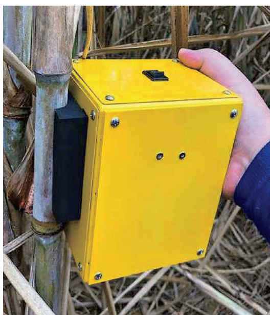
写真9 モバイルNIR糖度測定装置
