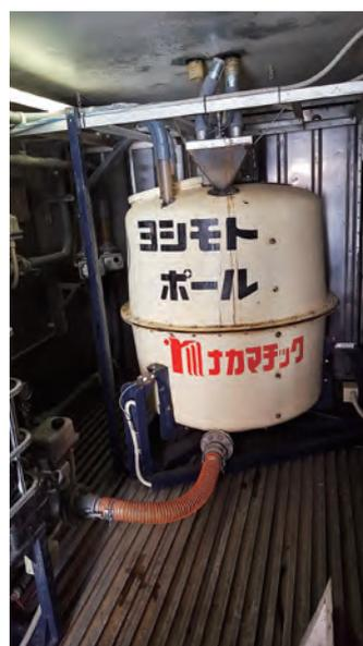
写真8 リキッド飼料調製コンテナ内のミキサー
