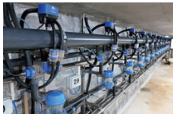
写真6 乳量計と飼養管理システムの一部
