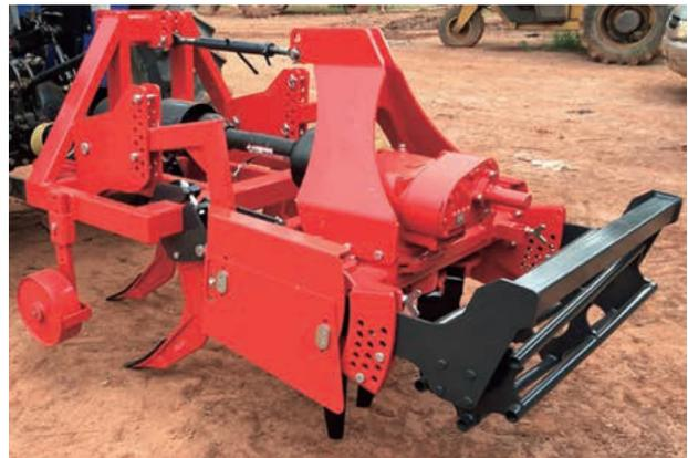
写真3 サブソイラ・パワーハロー一体型深耕機
