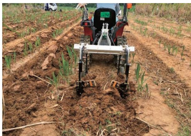
写真10 中耕作業機械（スガノスクープ）
