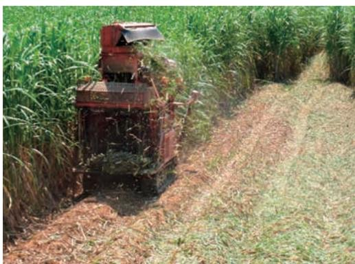
写真8 苗生産圃場におけるケーンハーベスタによる採苗の様子
