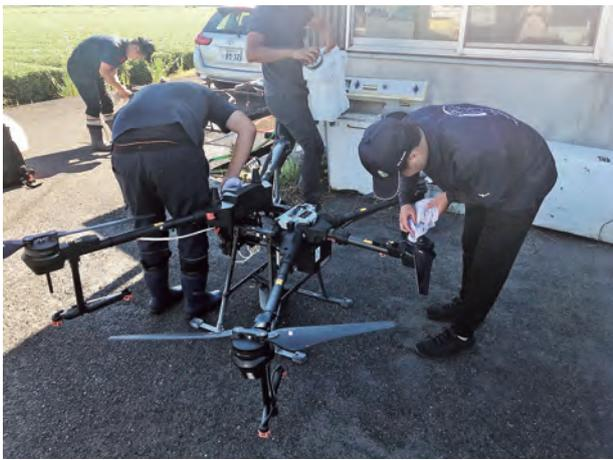
写真11 手拭きによるドローンの清掃
