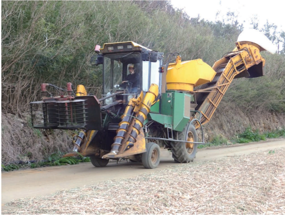
伴走車方式の車輪タイプ大型収穫機 (TOFT7000(EW))
