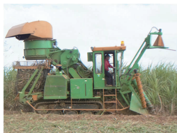
収納袋方式のクローラタイプ小型収穫機 (UT120K<BC>)
