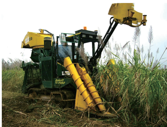
収納袋方式のクローラタイプ中型収穫機 (TS3850<BC>)
