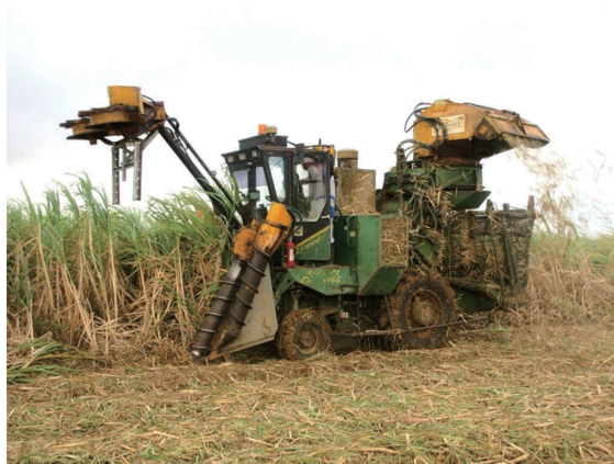
収納袋方式の車輪タイプ中型収穫機 (TS3500<BW>)
