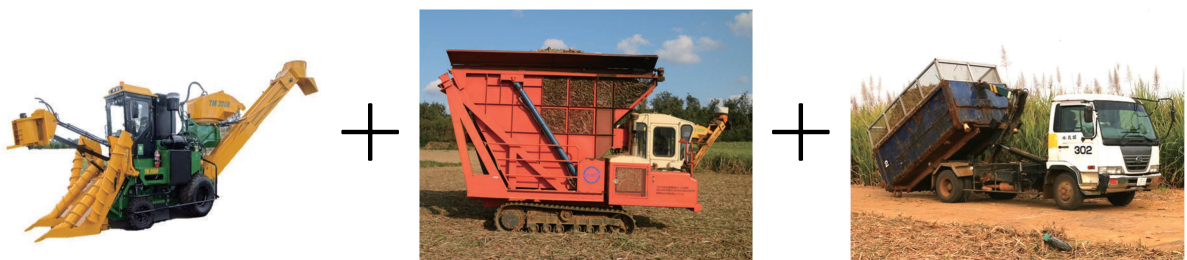
伴走車方式の車輪タイプ中型収穫機 (TM2008<EW>)
