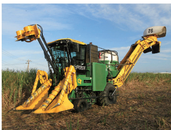
伴走車方式の車輪タイプ大型収穫機 (YT8000<EW>)
