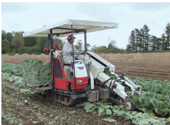
写真6 加工・業務用キャベツ収穫機による収穫の様子
