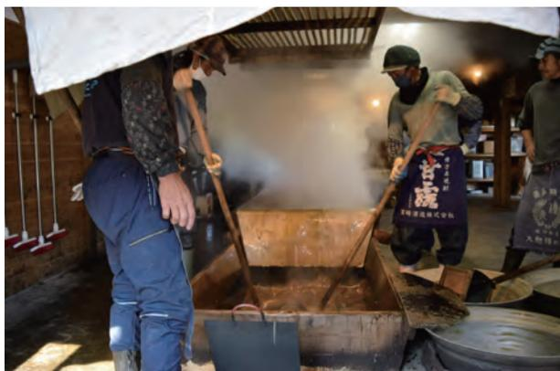
写真3 サトウキビ搾汁液を釜で濃縮させている様子
