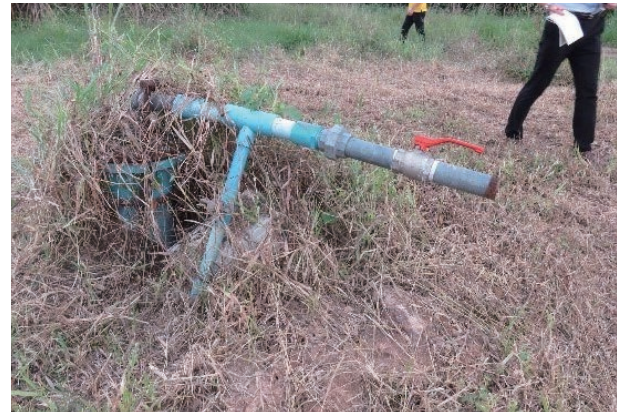
写真4 水源（貯水池）とポンプ（ポンプで水をくみ上げ圃場に供給）
