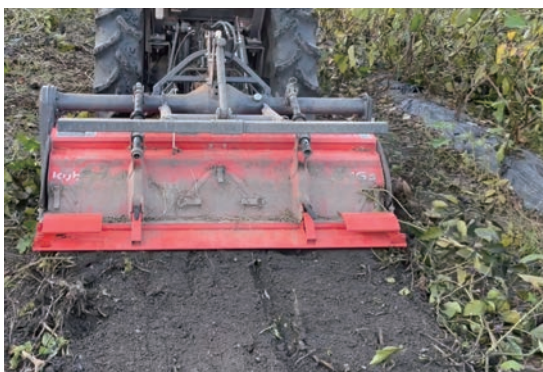
写真7 樹と一緒に生分解性マルチをすき込む様子（1回目の耕耘）
