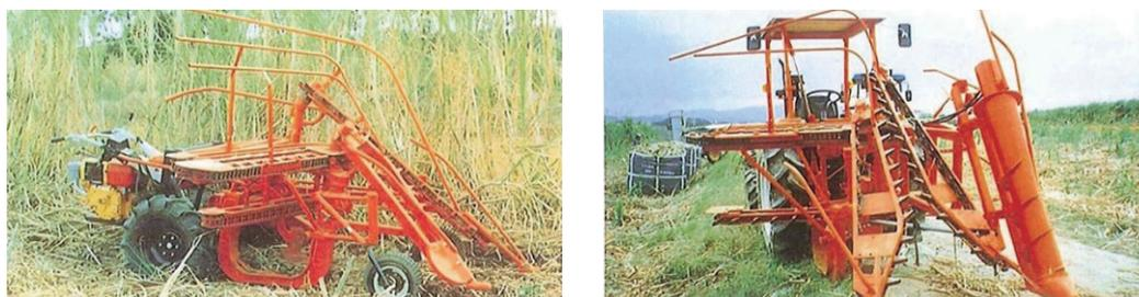
図10 粟国島で稼働する自走式刈り取り機（左）およびミニドラム脱葉機と搬出機（右）
