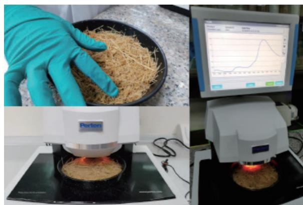
写真6 近赤外分光法による破碎サンプル測定の様子
