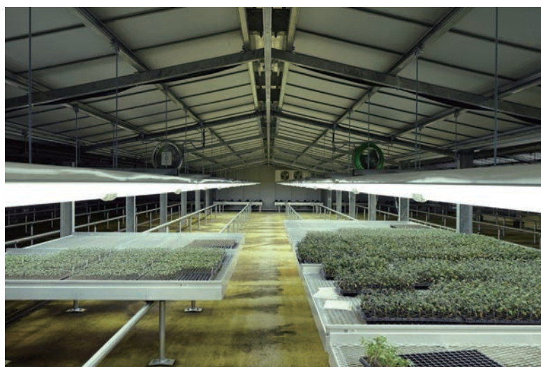
写真3 断熱壁で囲まれた閉鎖空間内でのLEDによる野菜苗の人工光育苗（株式会社九州野菜育苗センター、熊本県）
