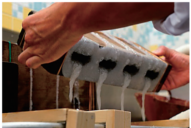
写真21 木型を軽く回してから、まだ熱い余分な糖液を流し出す。
