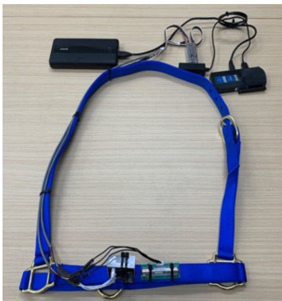
図 5-3-1 ウェアラブルセンサーの構成
