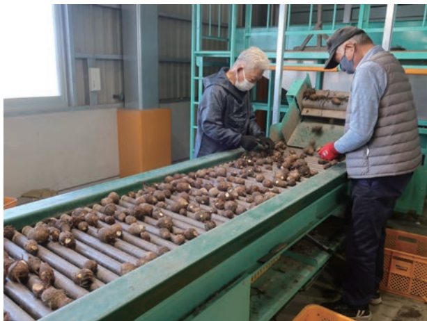
写真5 根切り・除泥ラインの機械を活用した調製作業
