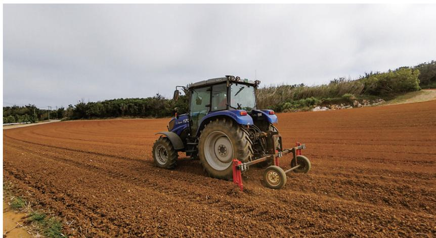
写真4 GNSSを利用した植え付け前の線引き作業の状況
