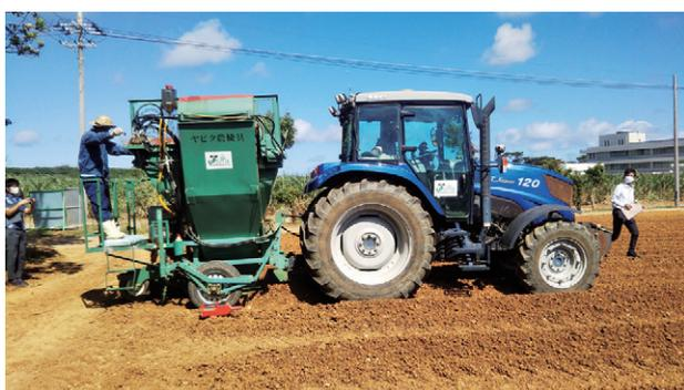
写真1 大型ビレットプランタによる植え付け作業
