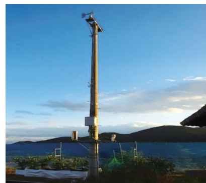
写真3 環境データ計測機器（フィールドサーバー） 生育・気象データ収集、分析を行う
