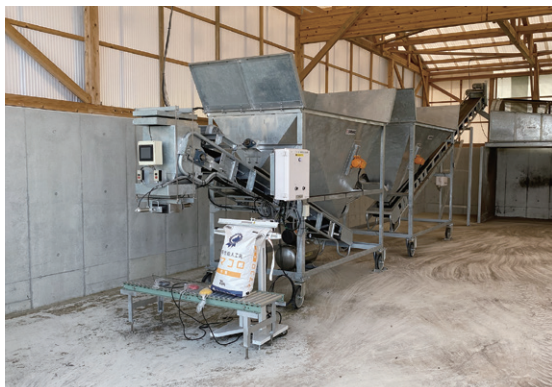
写真1 堆肥生産者が導入した堆肥ペレット化機械
