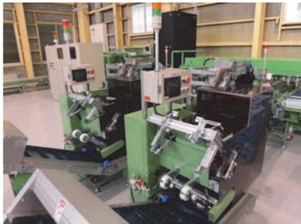
写真8 全自動計量結束装置
