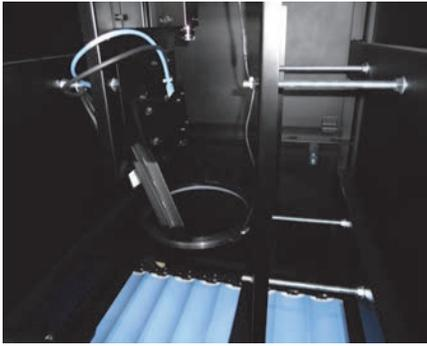
写真7 全自動カメラ形状判別機。高精度 CCD カメラセンサーを上部と側面に装備し、推定重量、色、形状（幅・しわ、曲りなど）、扁平を測定し、等階級を自動判別。
