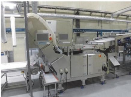
写真3 全自動色彩選別機。精度の高い形状認識が可能で、着色や大きさに加え、さやの破れなども検出可能。
