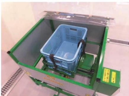
写真2 遠心脱水機。430回転/分の高速回転仕様。作業場所を選ばない移動式。
