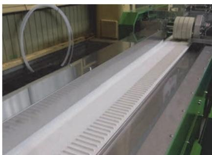
写真6 整列選果台。アスパラガスの穂先を傷めにくい構造で定寸カット用の自動根切カッターを装備。
