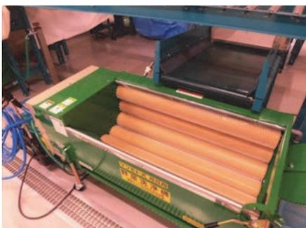
写真1 ブラシ洗浄機。独自開発の専用ブラシ(U字配列)によりむらなく洗浄することが可能で、付属の高圧洗浄機により頑固な汚れにも対応。
