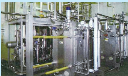
コラムー写真1 プレート殺菌機 (写真提供：くみあい乳業) 140度-2秒間で瞬時に殺菌
