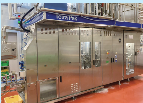
コラムー写真3 充填機 (写真提供：くみあい乳業)
