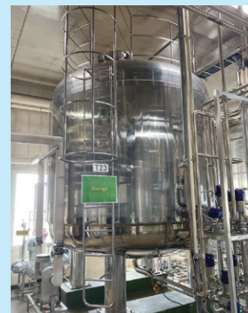
コラムー写真2 ストレージタンク (写真提供：くみあい乳業) 殺菌された牛乳は無菌保持タンクに 安全かつ衛生的に貯蔵
