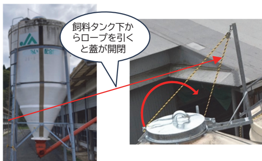
図6 飼料タンク蓋遠隔開閉装置およびセンサーによる在庫管理の概要 飼料タンク蓋遠隔開閉装置 センサーによる在庫管理
